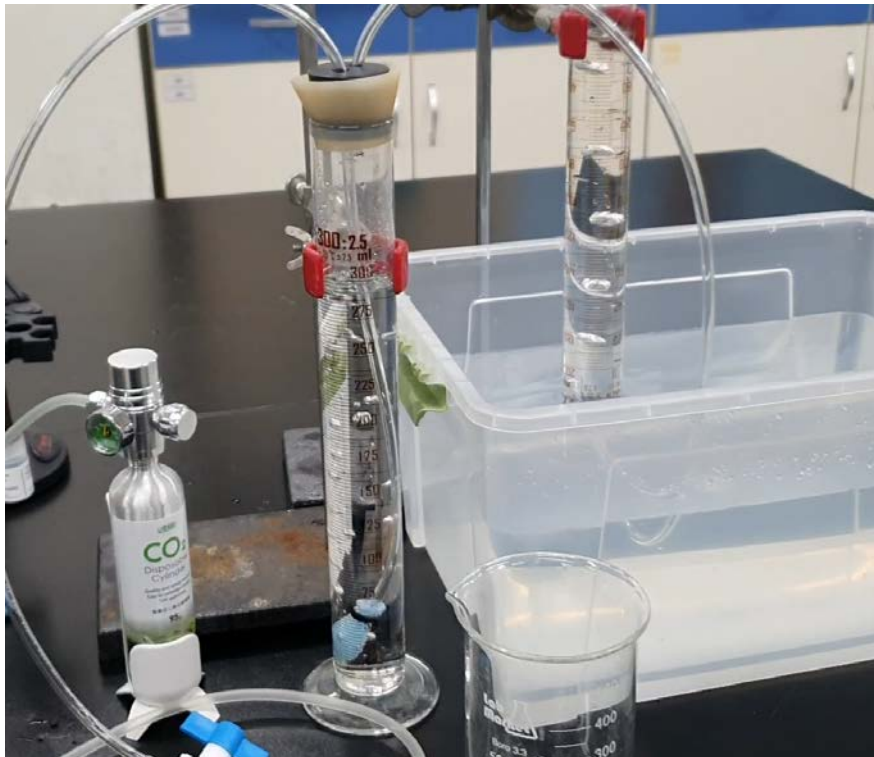
<그림 9. CO 2 를 공급하였을 때 실험 장치의 모습 (기체 방울 생성)>
