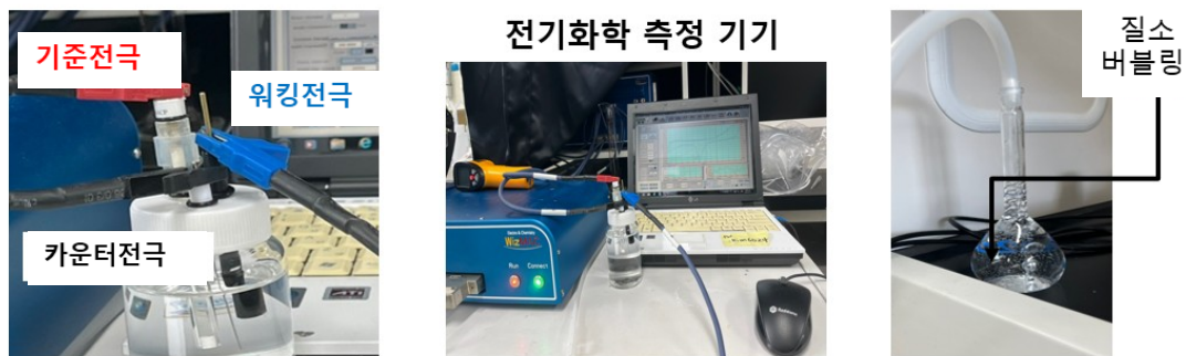
그림7. 전기화학 측정 전극 및 측정기기와 질소 버블링
