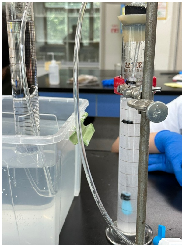
<그림 12. 수산화바륨 용액 B에 의한 CO 2 포집>
