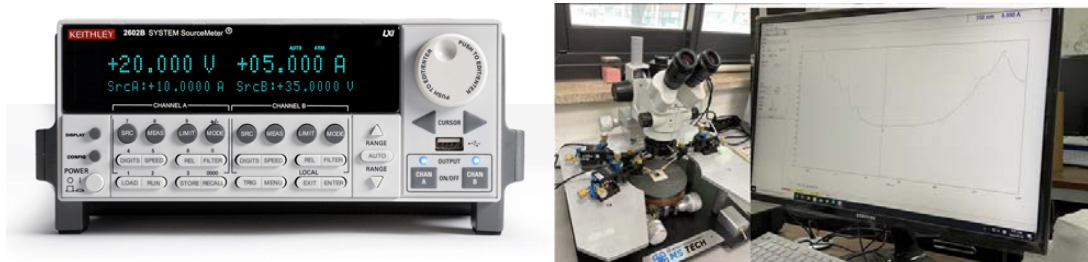
그림9. TFT 소자 특성 평가 장비 및 측정 과정
